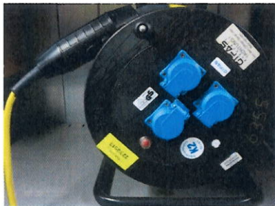
Leitungsroller K2 mit integriertem PRCD-S
